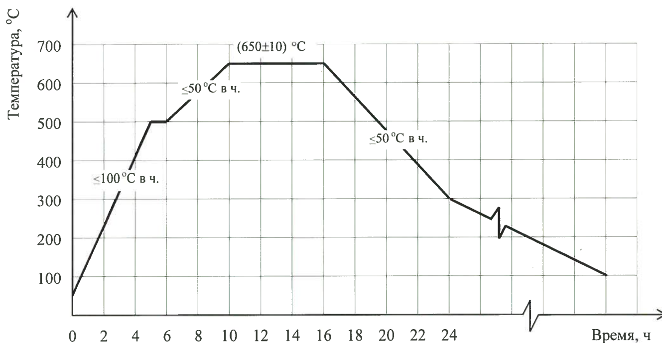
Рисунок 4 – Схема режима окончательного высокого отпуска для монтажных соединений ГЦТ, ГЦТ с патрубками ГЦНА
